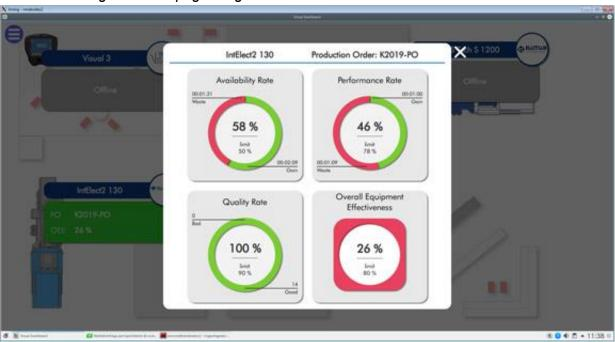
Los controles robóticos de Sepro recolectan una gran cantidad de datos de producción, que se pueden utilizar para calcular la OEE y otras métricas para representarlas en el Tablero Visual nuevo.
