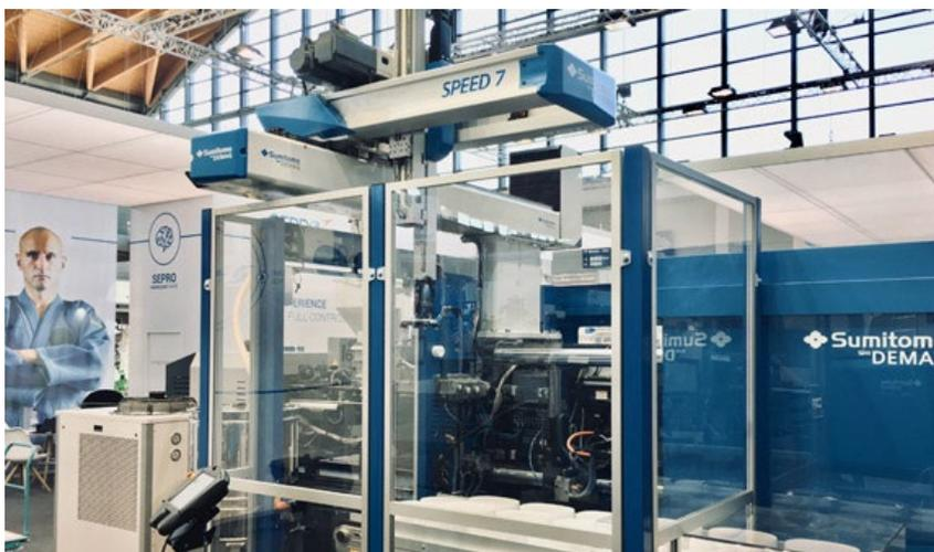
*Uma das duas células de automação no stand da Sepro apresentará uma máquina injetora Sumitomo Demag equipada com um robô SDR Speed 7. Produzido pela Sepro especialmente para venda com máquinas Sumitomo Demag, esse robô consegue entrar e sair do molde em menos de 1 segundo. Faça o download do arquivo de alta resolução: <https://tinyurl.com/SRO-Speed7>*
