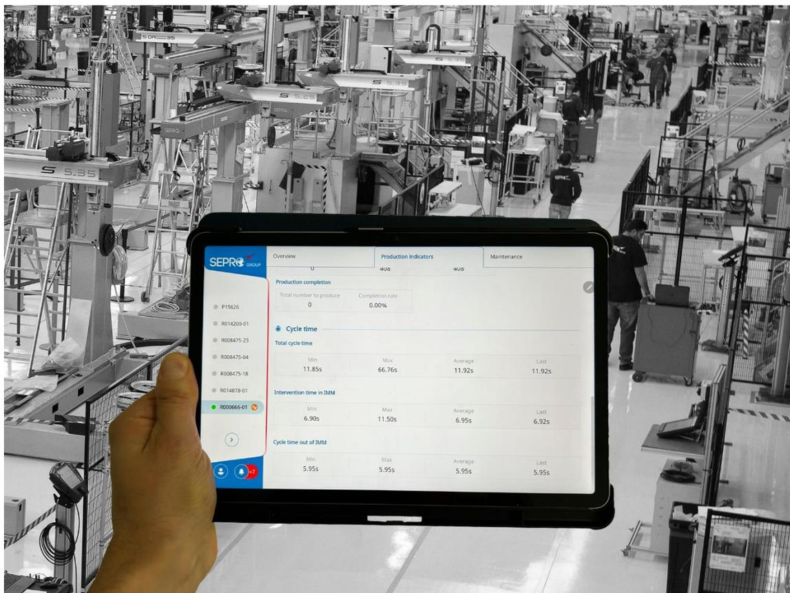
*Le nouveau tableau de bord Sepro Connect pour cellules d'automatisation du groupe Sepro rassemble de manière homogène les données de tous les équipements des cellules automatisées de moulage par injection de plastique - y compris les machines de moulage - et promet de transformer la manière dont les fabricants de produits en plastique gèrent leur production, améliorent leur productivité globale et contrôlent leur consommation d'énergie.*
